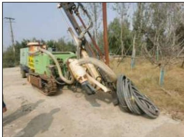
钻孔机自带集尘罩和布袋除尘器
