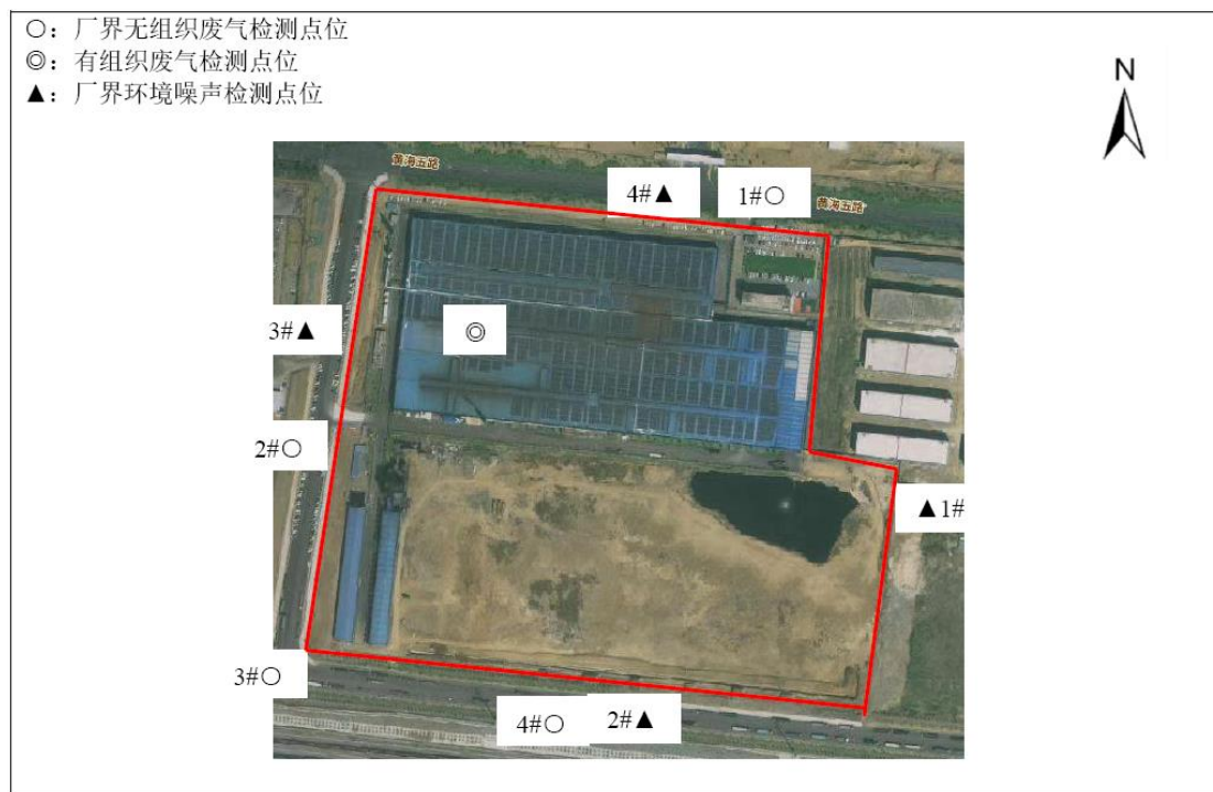
图 7-1 项目废气、噪声监测点位平面布设示意图
