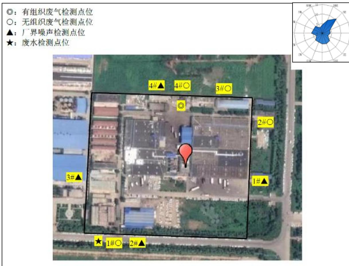
图 6-1 项目废气、废水、噪声监测点位平面布设示意图
