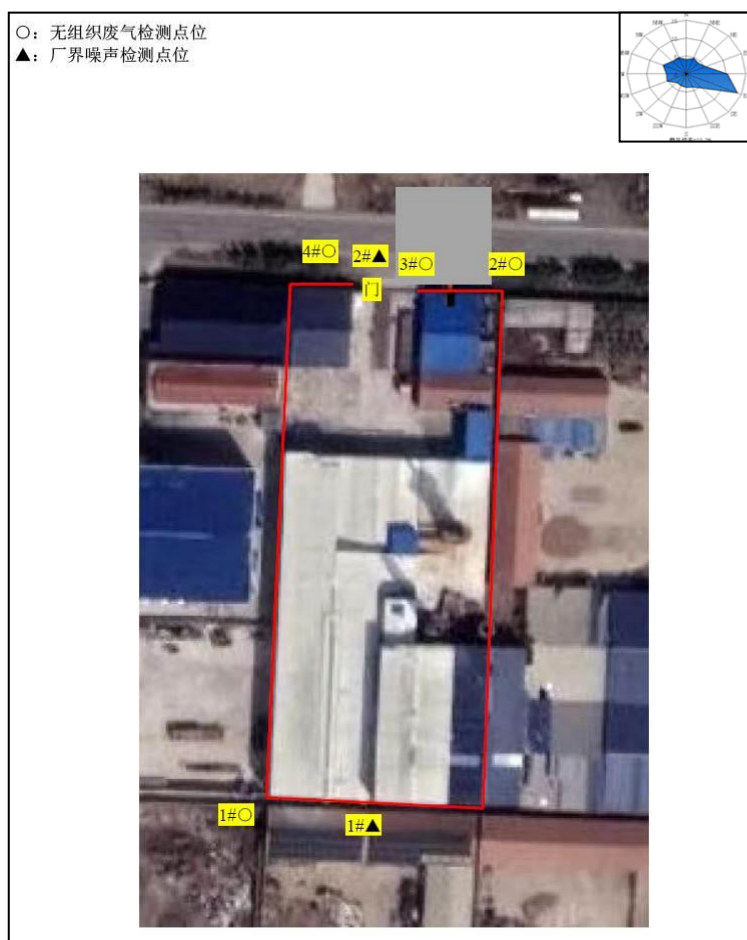
图 6-1 项目无组织废气、噪声监测点位平面布设示意图
