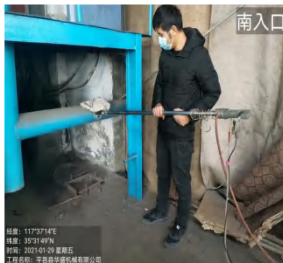
电炉熔炼废气南侧处理前现场检测图
