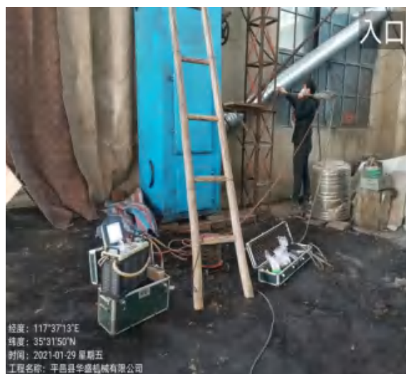
电炉熔炼废气北侧处理前现场检测图
