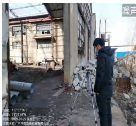
噪声现场检测图
