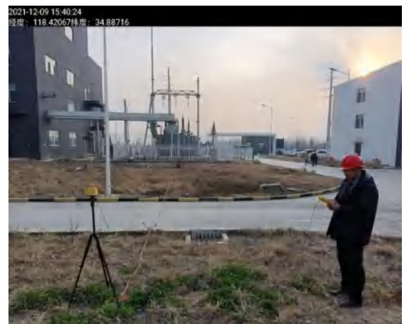
9#站址北侧围墙外距围墙 30 米处 辐射现场检测图
