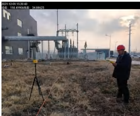
7#站址北侧围墙外距围墙 20 米处 辐射现场检测图
