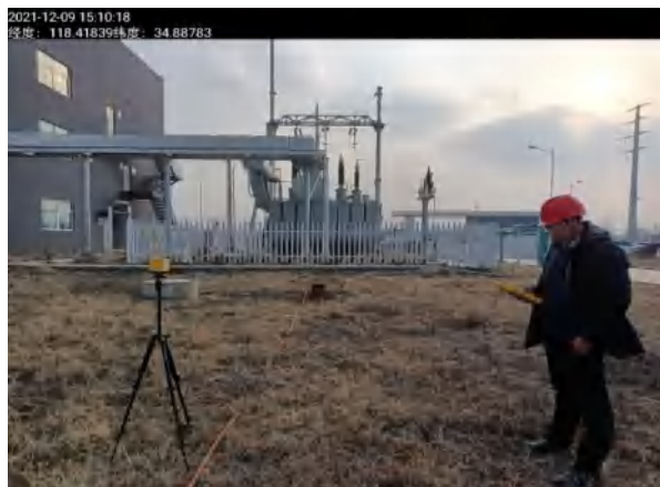
6#站址北侧围墙外距围墙 15 米处 辐射现场检测图
