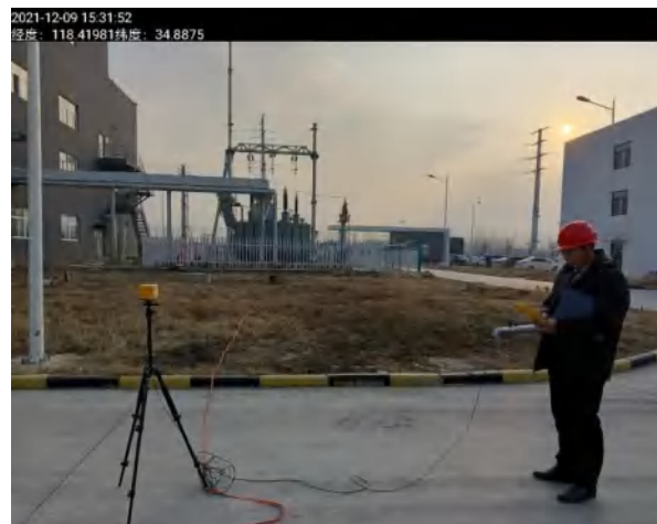
8#站址北侧围墙外距围墙 25 米处 辐射现场检测图
