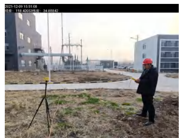
10#站址北侧围墙外距围墙 35 米处 辐射现场检测图
