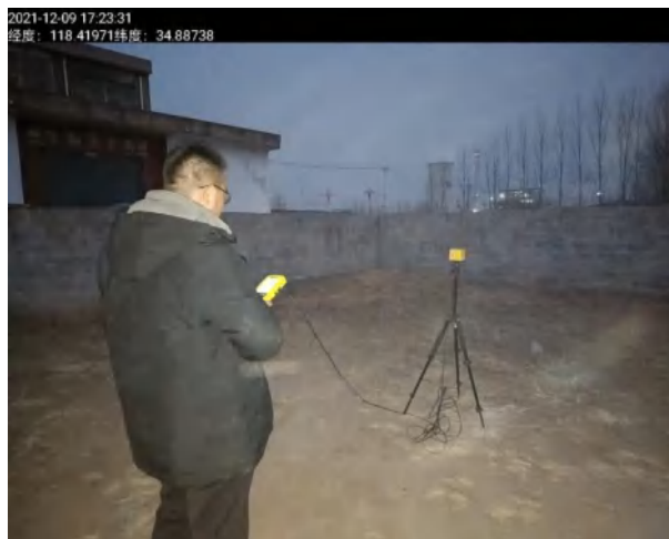
图 14: 14#李庄社区辐射现场检测图
