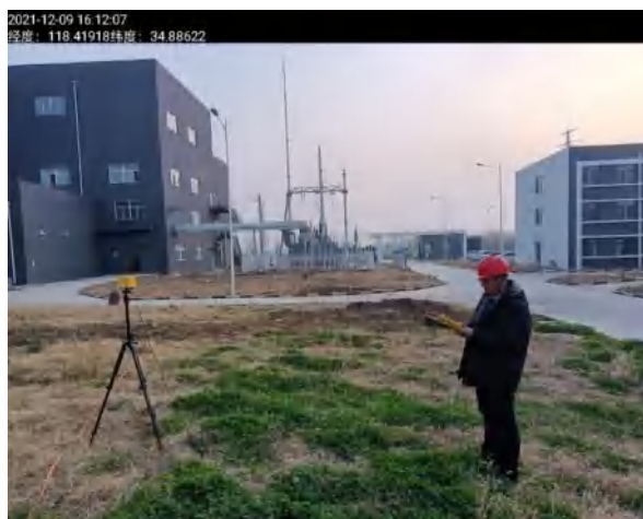
12#站址北侧围墙外距围墙 45 米处 辐射现场检测图
