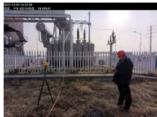
4#站址北侧围墙外距围墙 5 米处 辐射现场检测图
